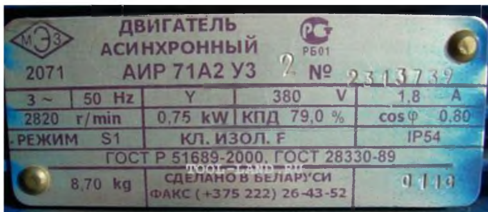
Табличка разбираемого электродвигателя
