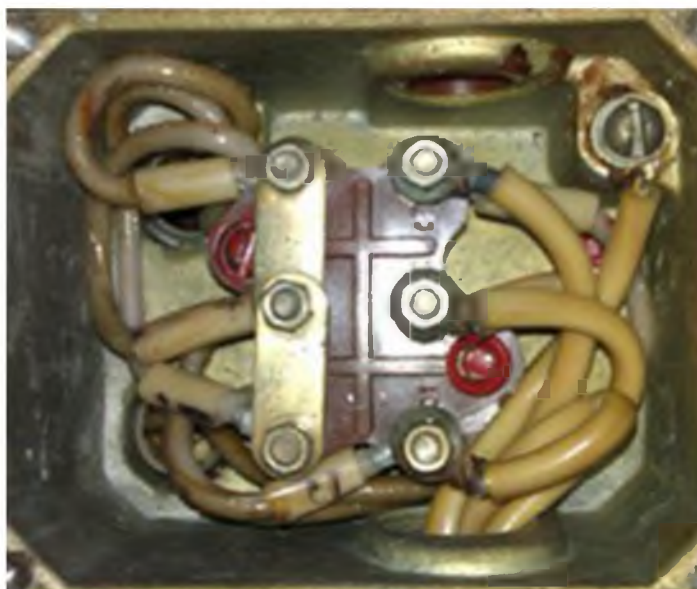
Распределительная коробка трехфазного двигателя с положением перемычек для подключения по схеме звезда
