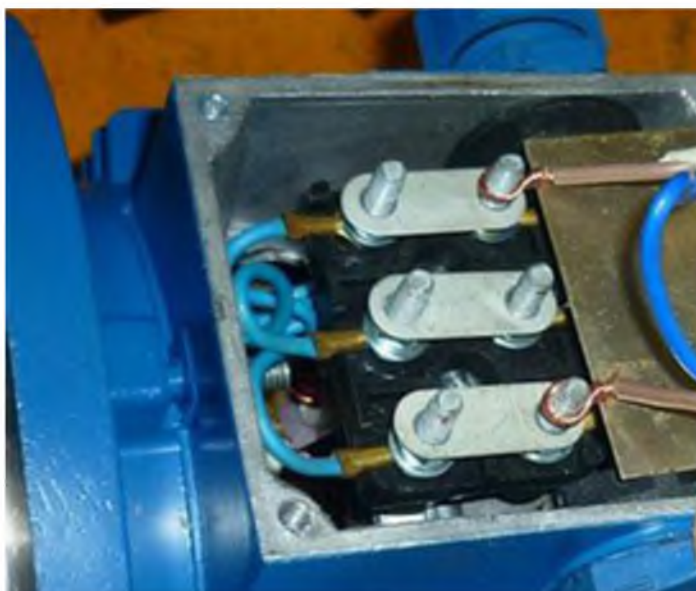
Подключение обмоток асинхронного двигателя треугольником
