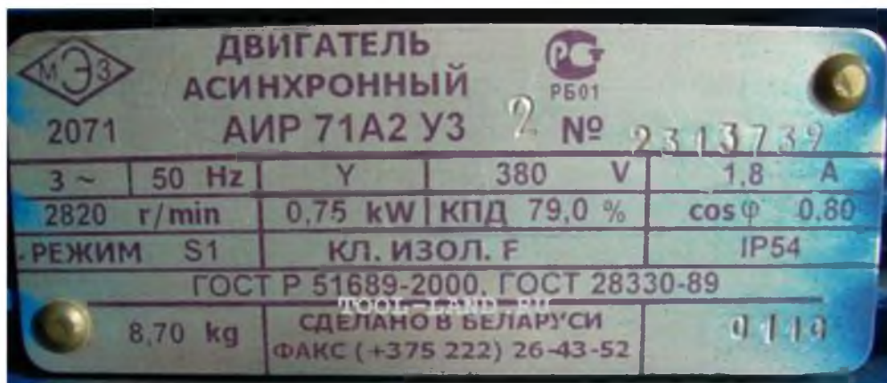
Табличка разбираемого электродвигателя
