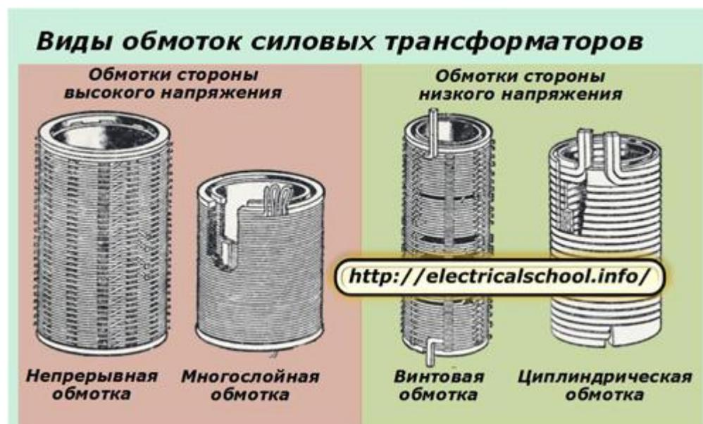
По обмоткам фаз трансформатора протекает ток нагрузки. Материалами для их изготовления выбирают металлы: медь или алюминий с круглым либо прямоугольным сечением. Для изоляции витков используют специальные сорта кабельной бумаги или хлопчатобумажную пряжу.
