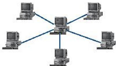
остальные периферийные компьютеры, причем каждый из них использует свою отдельную линию связи. Весь обмен информацией идет исключительно через центральный компьютер, на который ложится очень большая нагрузка, поэтому он предназначен только для обслуживания сети.
