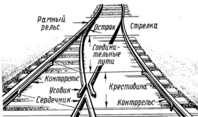
Рис. 1 – Общий вид стрелочного перевода
