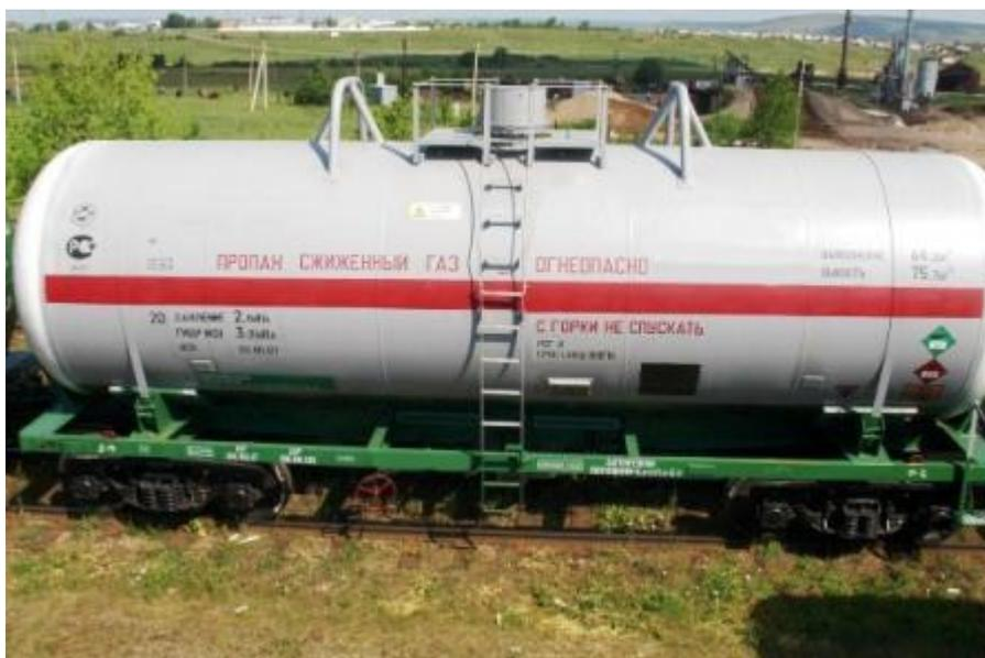
Жидкие грузы (нефть, керосин, бензин, масло, кислоты и т.п.) перевозят в цистернах. Цистерна представляет собой специальный металлический сварной резервуар (котел) цилиндрической формы, имеющий в верхней части люки для наливания груза, очистки и ремонта. Разнообразие грузов обуславливает существенные различия в конструкции цистерн.
