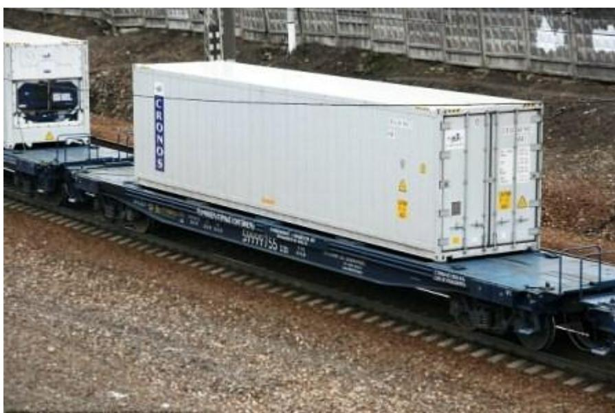
На платформах перевозят длинномерные, громоздкие и тяжеловесные грузы. Платформы оборудуют невысокими откидными металлическими бортами и приспособлениями для установки стоек, необходимых при перевозке бревен, столбов, досок и т. п. Грузоподъемность современных платформ составляет 70...72 т. Для перевозки крупнотоннажных контейнеров массой брутто 10, 20 и 30 т выпускают специальные четырехосные платформы, снабженные фитингами — устройствами для установки и крепления контейнеров.
