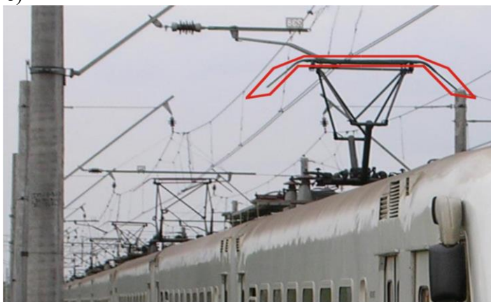
Рис. 2.7 – Верхнее очертание габаритов приближения строений
