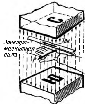
Рис. 48. Электромагнитная сила, действующая в магнитном поле на проводник с током
