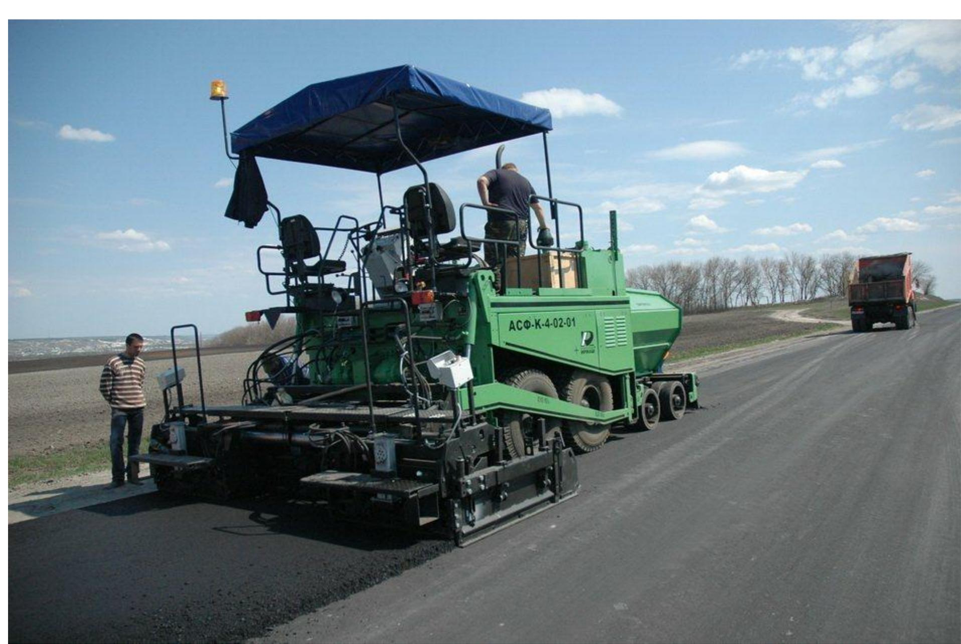
**Асфальтоукладчик** предназначен для распределения по поверхности основания слоя горячего асфальтобетона так, чтобы покрытие имело ровную поверхность, одинаковую (по длине и ширине) толщину и могло выдержать массу тяжёлых катков, используемых для его окончательного уплотнения и выравнивания.
