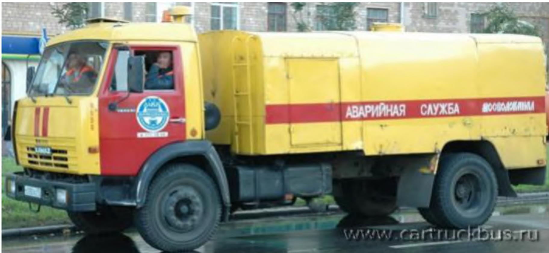
**Шасси — КамАЗ-43253. Передвижной компрессор**
