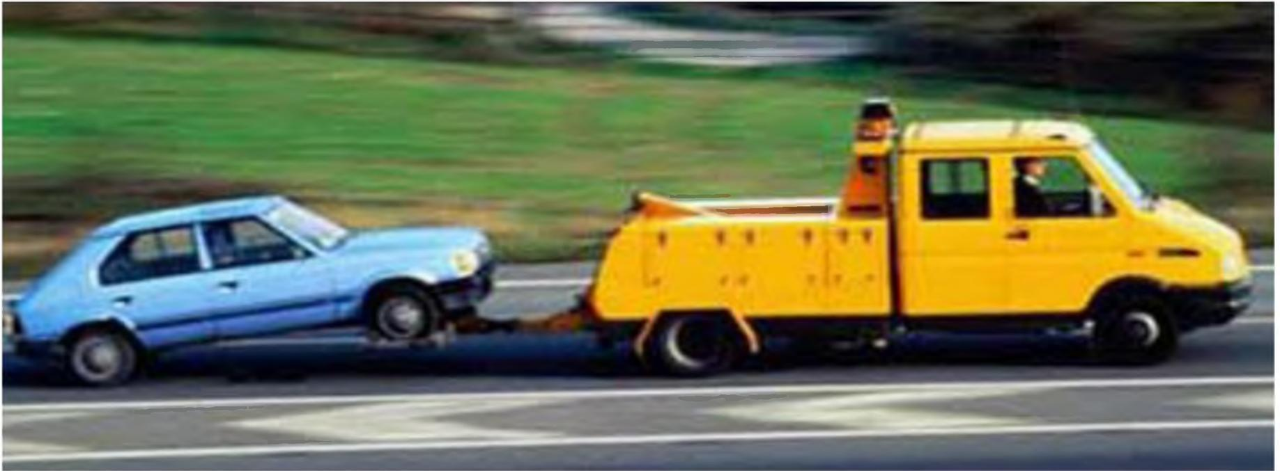
**Одной из разновидностей такой буксировки является способ, при котором автомобиль-тягач оснащён специальным устройством, позволяющим вывесить либо передний, либо задний мост буксируемого автомобиля.**
