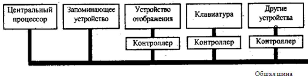
Рисунок 1- Архитектура компьютера открытого типа
