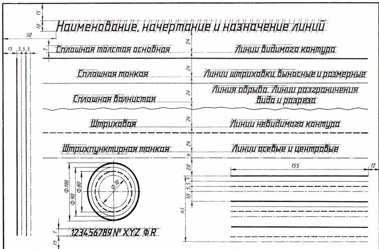
Выполнить графическую работу №1 в соответствии с данным изображением. Работу выполнять на листе формата А4, размеры не проставлять.
