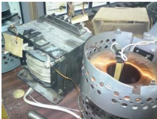
Трансформатор и автотрансформатор
