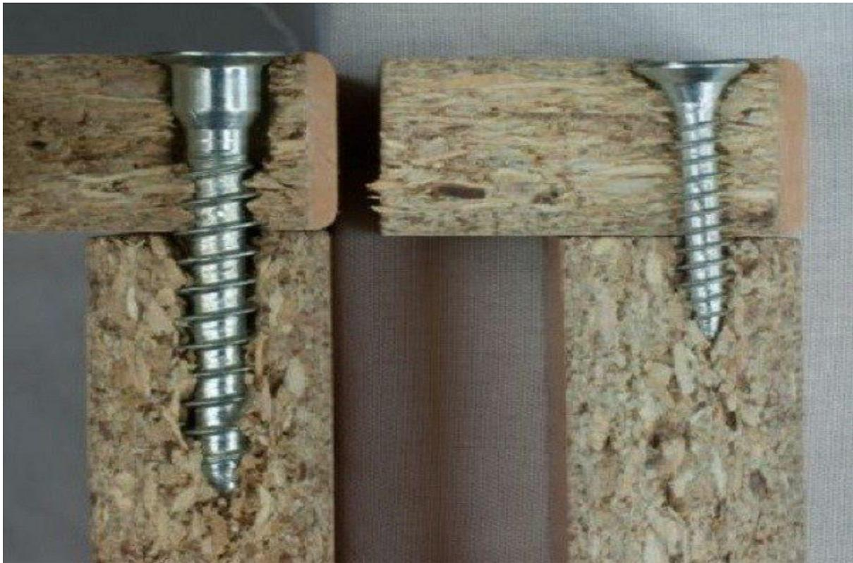
При частом вкручивании/выкручивании конфирмат повреждает детали мебели, что негативно сказывается на прочности мебели.
