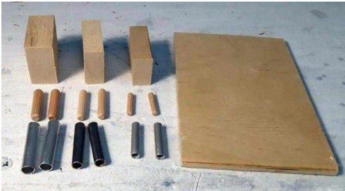
**Шаг № 1 – отверстия.** В деревянных брусках следует сделать сквозные отверстия, важно чтобы они были расположены строго под углом 90 градусов. Диаметр сверла должен соответствовать размерам металлических трубок.
