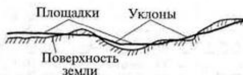
Рис.3.2 Элементы продольного профиля железнодорожной линии
