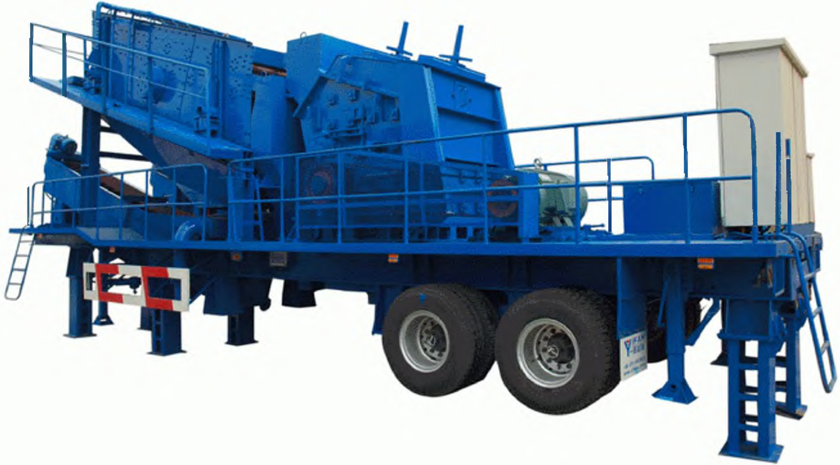
Передвижная дробильно сортировочная установка. роторная дробилка
