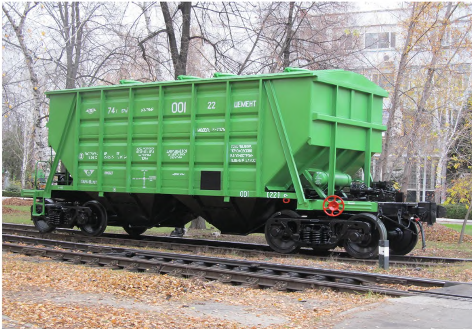
Вагон-хоппер для перевозки цемента модель 19-7075
