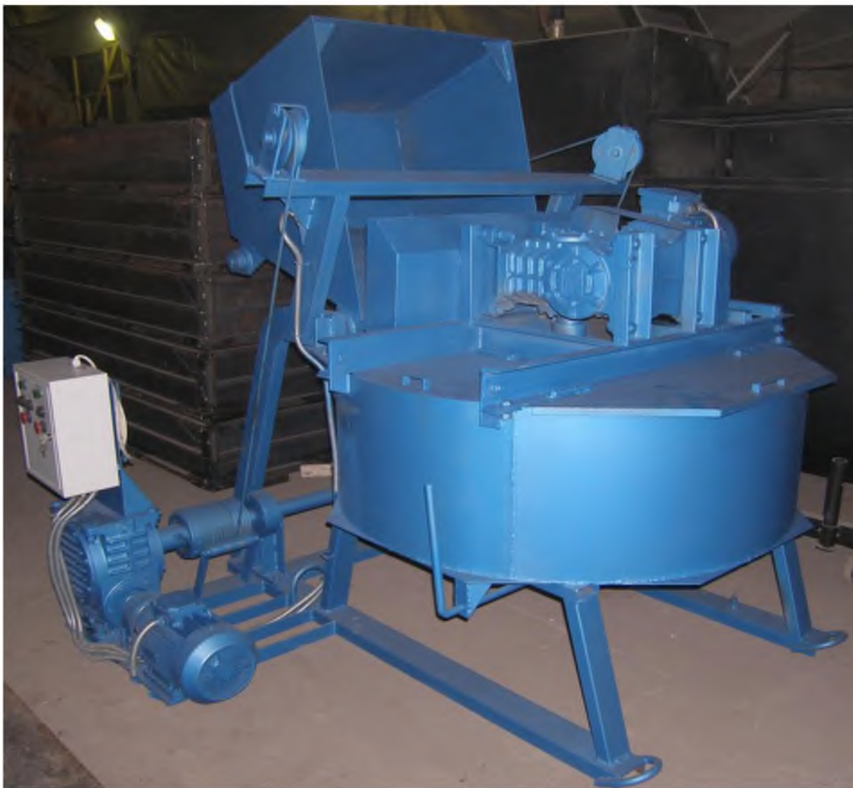
Бетоносмеситель СБ-80-03 — циклическая машина с неподвижной чашей, оборудованной броней, и смесительным устройством роторного типа.
