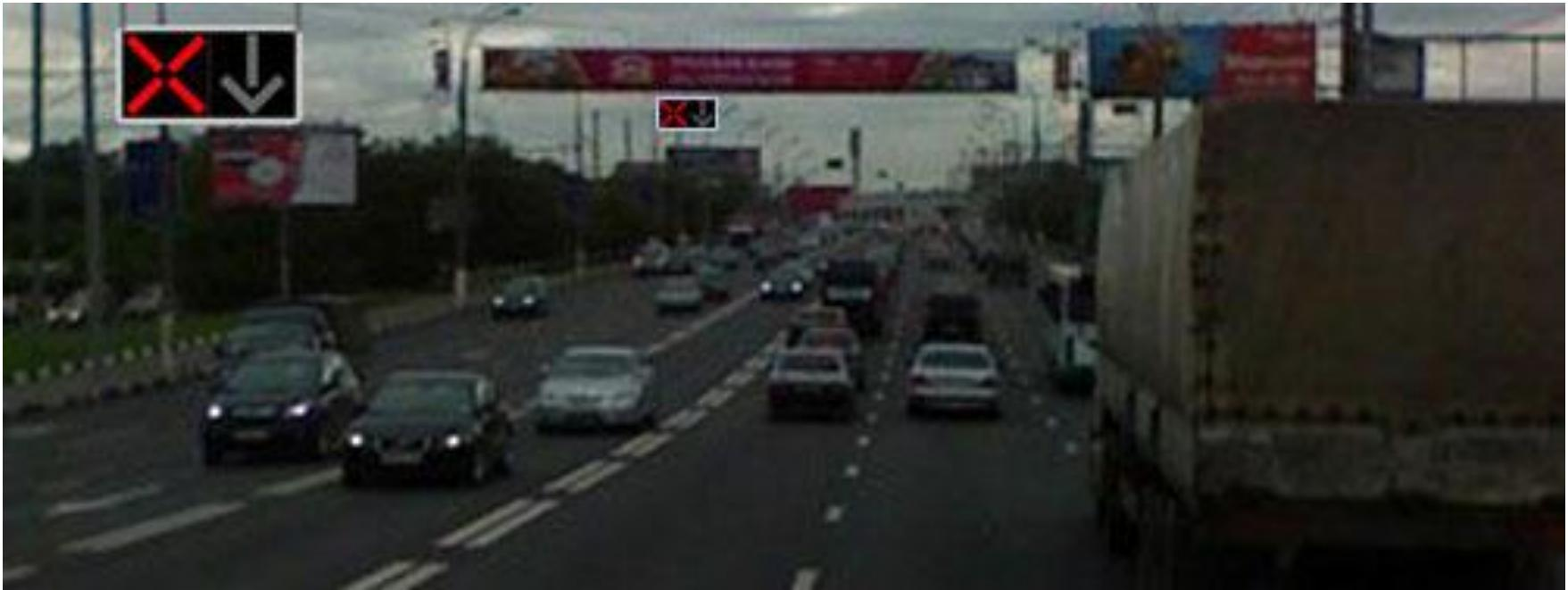
На этом участке дороги для реверсивного движения выделена только одна полоса. И сейчас на реверсивном светофоре нам горит красный крест. И, следовательно, сейчас реверсивная полоса отдана водителям встречного направления.
