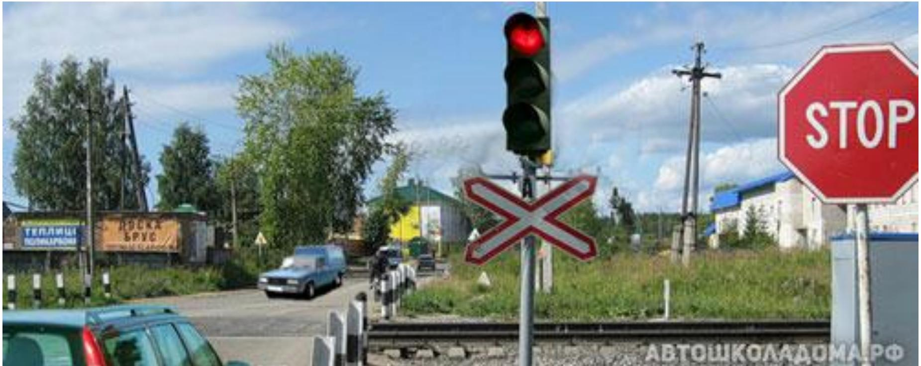
В завершении отметим, что ГОСТ допускает применение на железнодорожном переезде и обычных транспортных светофоров.
