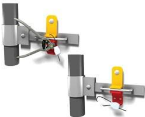
Рис. 1. Способ снятия стержневого ЗПУ с контейнера
