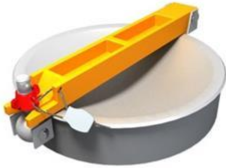
Рис. 14. Схема установки универсального ЗПУ с длиной каната 300 мм на верхней крышке загрузочного люка цистерны ригельного типа при наличии пломбировочных проушин
