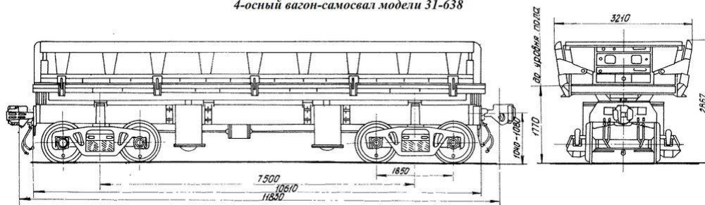
4-осный вагон-самосвал модели 31-638
